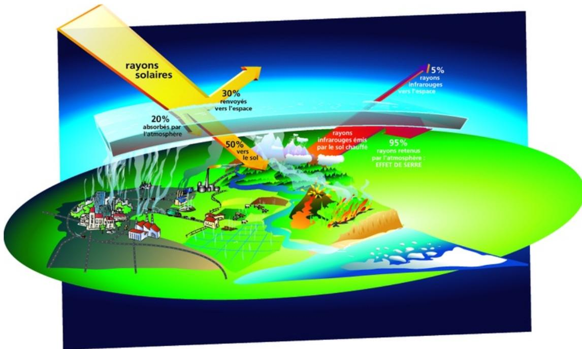
La lumière du Soleil traverse l'atmosphère et chauffe le sol. Le sol ainsi chauffé émet des rayons infrarouges dont une partie est retenue dans l'atmosphère par les gaz à effets de serre.
