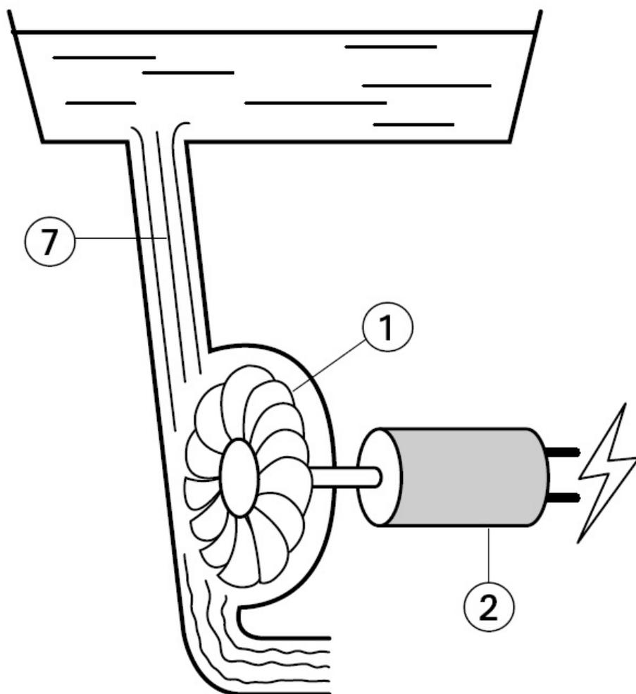
Une **centrale hydraulique** utilise la **force de l'eau** (courant, chute ou marée) pour faire tourner les turbines. Celles-ci actionnent ensuite des alternateurs qui produisent de l'**électricité**.
