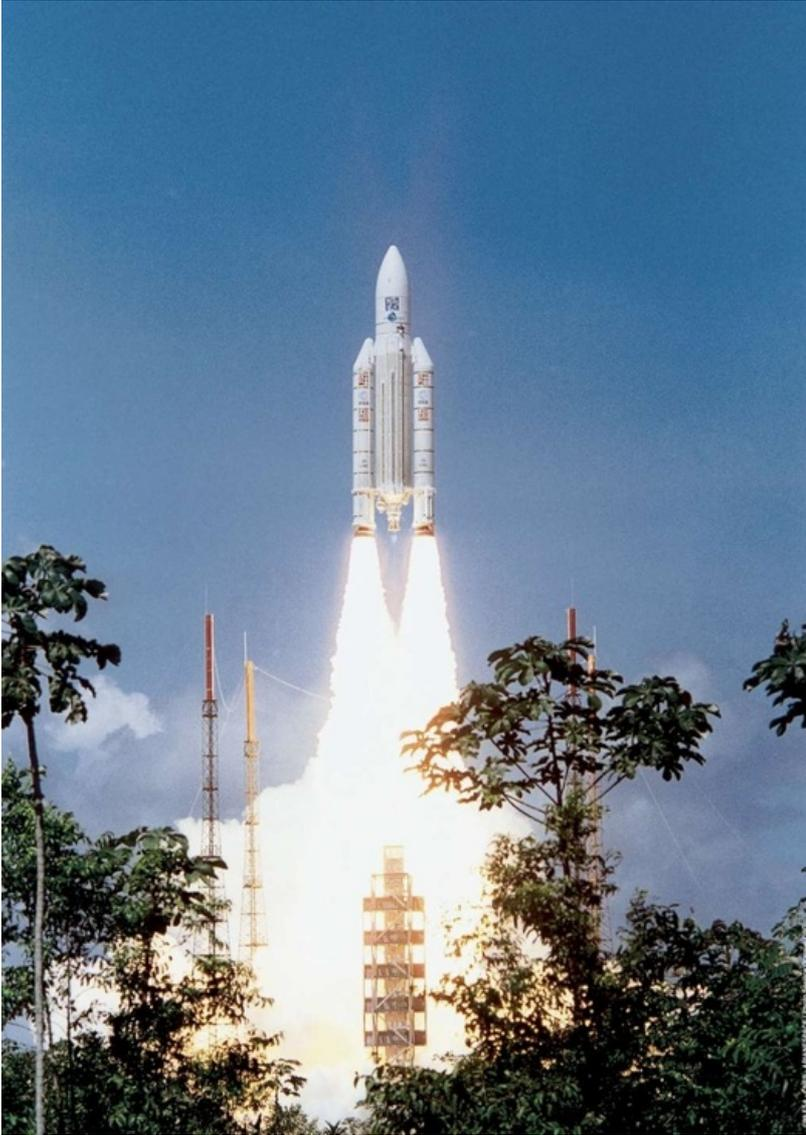
Deux ergols – l'un appelé combustible et l'autre comburant (oxydant qui brûle le combustible) – réagissent l'un sur l'autre dans la chambre de combustion du moteur de la fusée. Les gaz formés par la combustion des ergols acquièrent leur vitesse finale d'éjection par détente et accélération dans la tuyère du moteur. La force créée par l'éjection des gaz (action ou poussée) propulse le lanceur en direction opposée (réaction).
