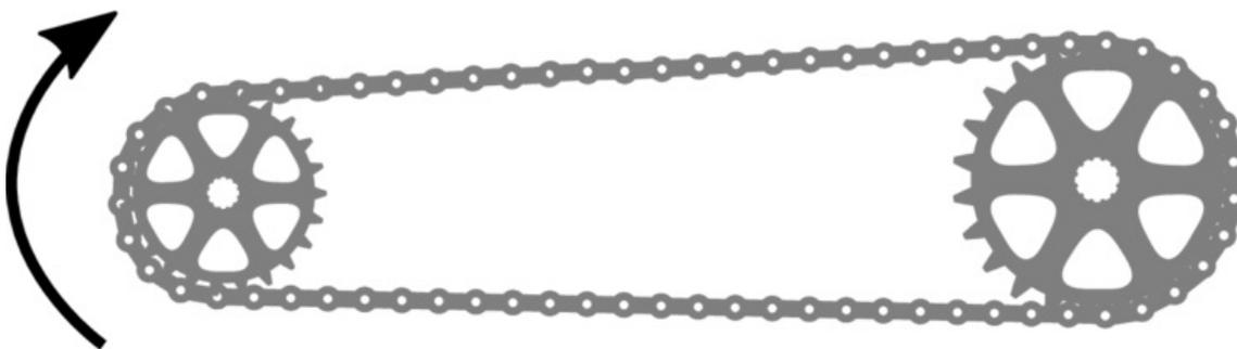
• Le rapport de réduction est :  $R = \frac{Z_{motrice}}{Z_{receptrice}} = \frac{D_{motrice}}{D_{receptrice}}$ , où  $Z$  = nombre de dents et  $D$  = diamètre.
