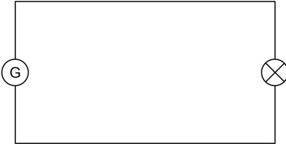
Exemples de circuits en série
