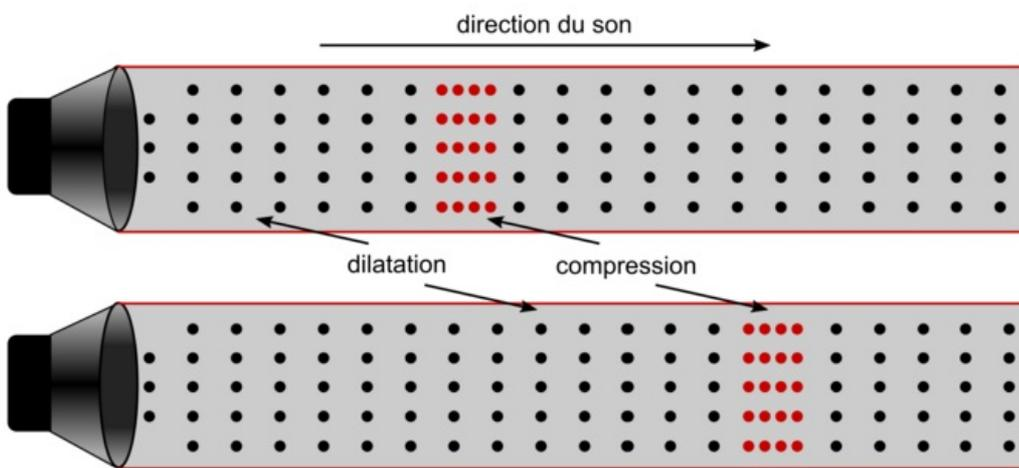
• La **pression acoustique** (exprimée en pascal, Pa) est la variation de pression du fluide en un point donné, par rapport à sa valeur d'équilibre. C'est une fonction sinusoïdale du temps :
